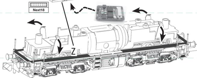
**Einbau eines digitalen Empfängerbausteins:**
